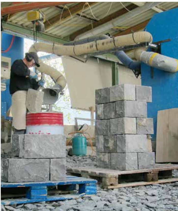
Usiner de pierres de mur
