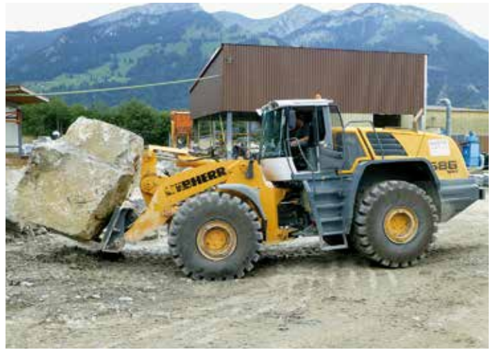
Chargeuse L586 de Liebherr, 25t de poussée
