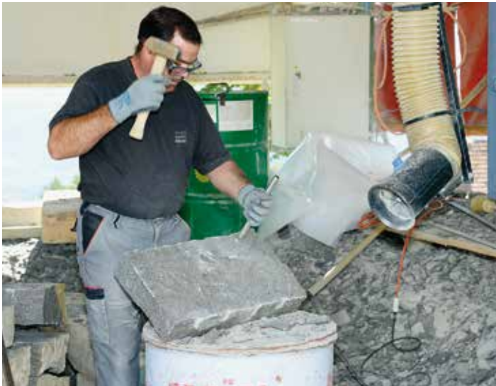
Usiner de planches clivées grossièrement
