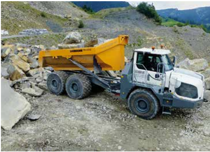
Dumper TA230 de Liebherr avec auge de 19m 3 et quatre roues automotrices
