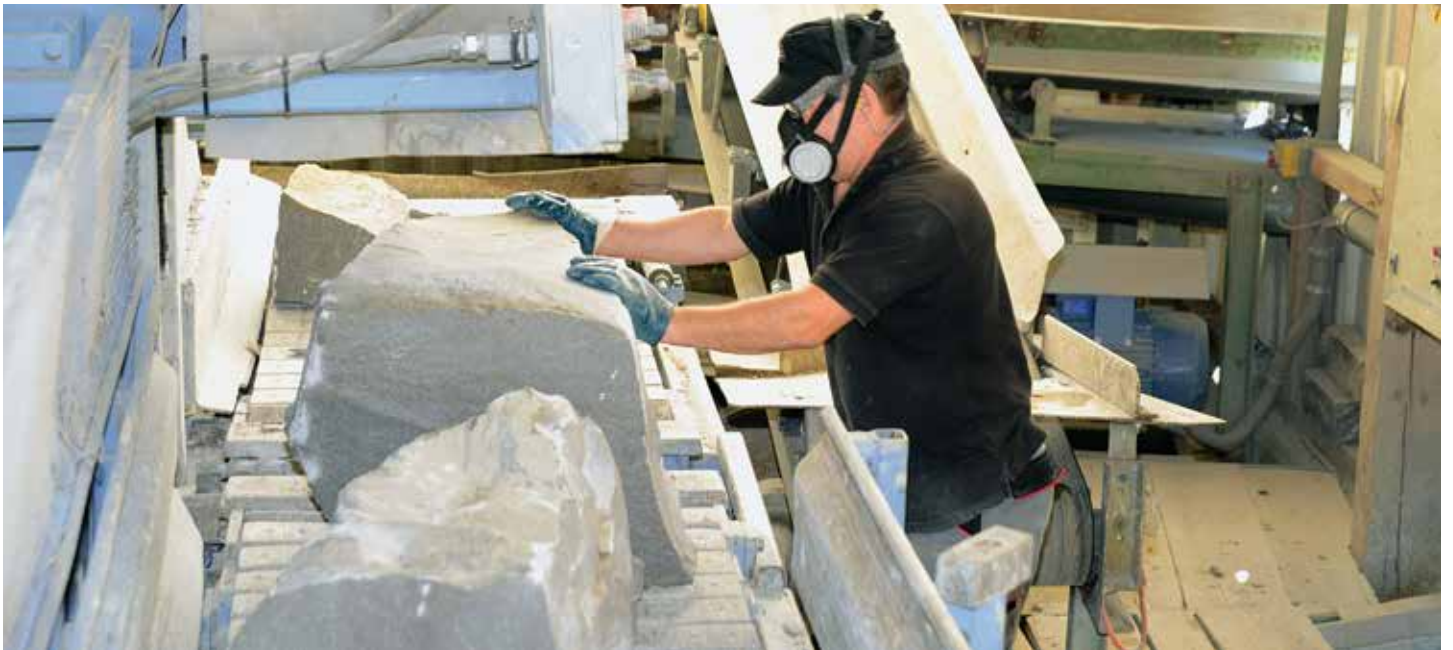
Installation de clivage de 150t pour préparer de pierres délitées à la production de pavés
