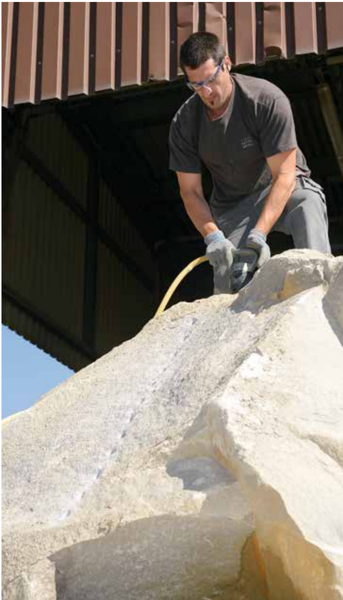
Blocs bruts à préparer avec le pic pour le clivage
