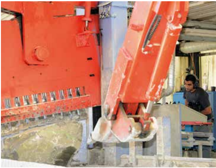
Installation de clivage de 650t pour cliver de blocs bruts
