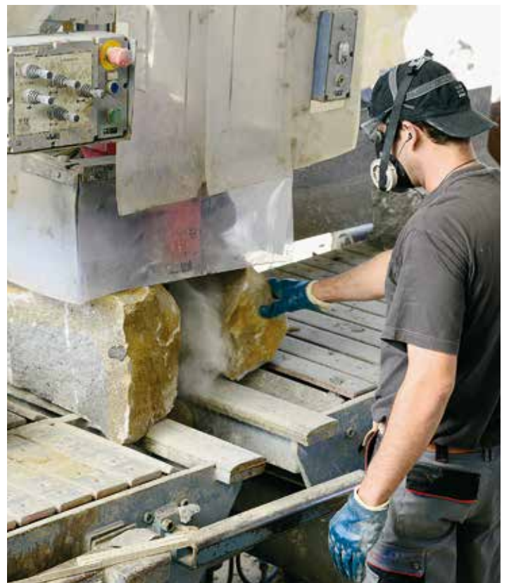
Cliver de pierres de mur sec avec installation de clivage de 150t
