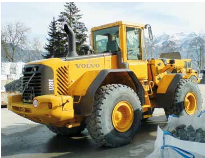
Chargeuse sur pneu L120E de Volvo avec 14t de poussée pour le chargement de poids lourd
