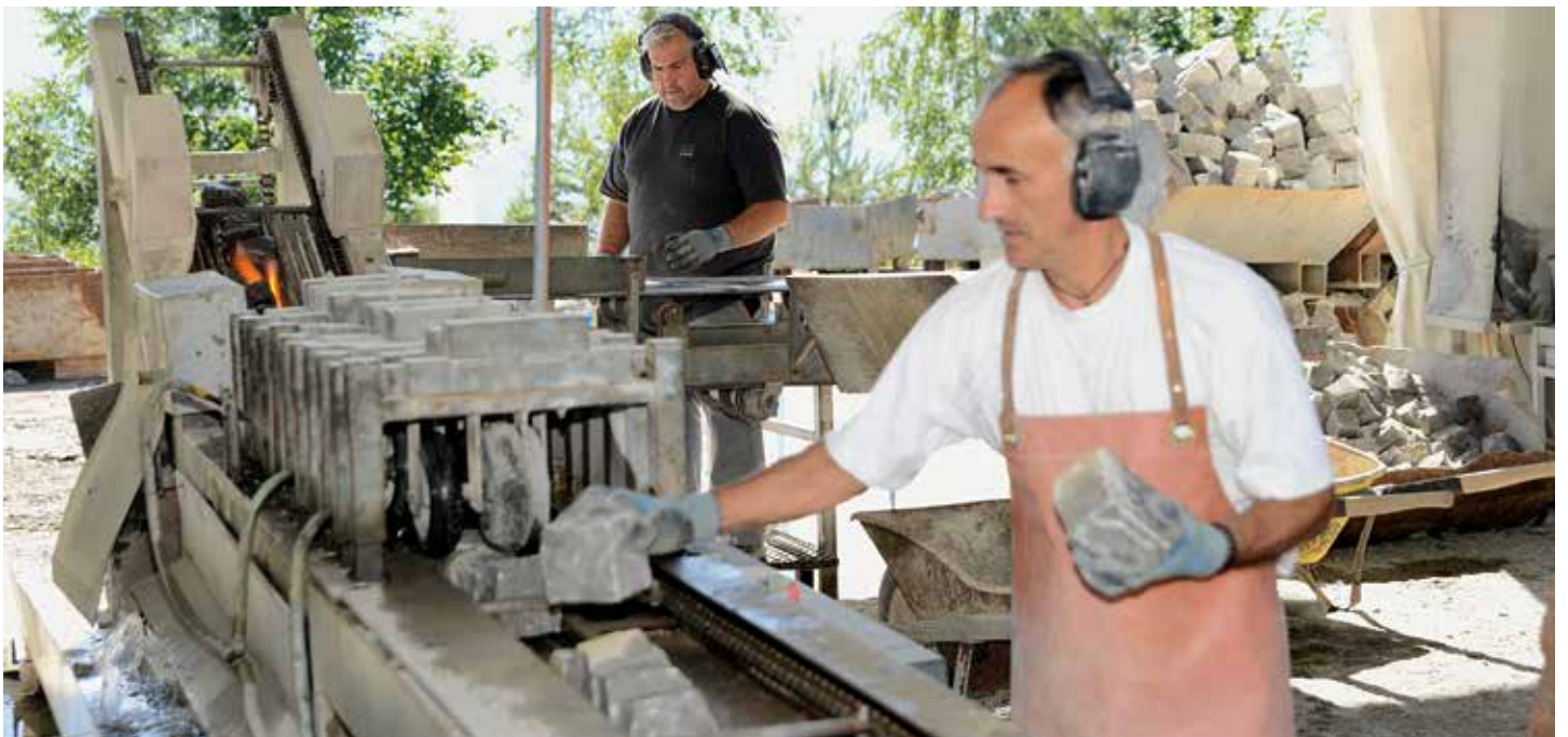
Abraser et flammer de pavés pour de revêtements adaptés aux handicapés
