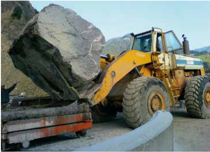
Chargeuse sur pneu International avec 25t de poussée
